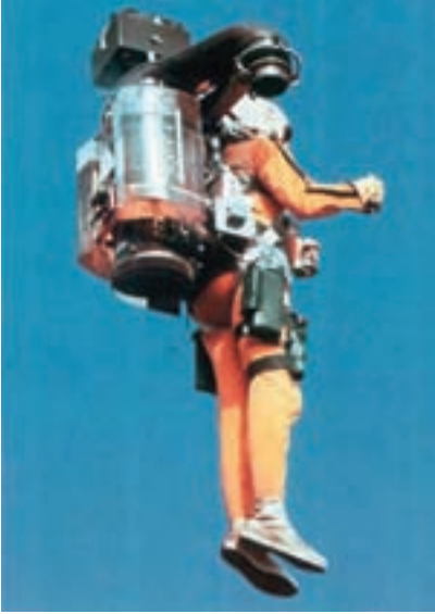
Moore'un yaptığı sırt roketiyle istendiği gibi uçulabiliyordu. Ancak bu uçuş çok kısa sürüyordu.
