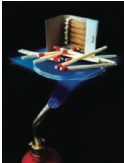
Aerojel, hem çok hafiftir hem de çok iyi bir yalıtıcıdır. Altında yanan alevin kaldırabildiği aerojel, yalıtıcılığı sayesinde de üzerindeki kibritler yanmadan durabiliyor.
