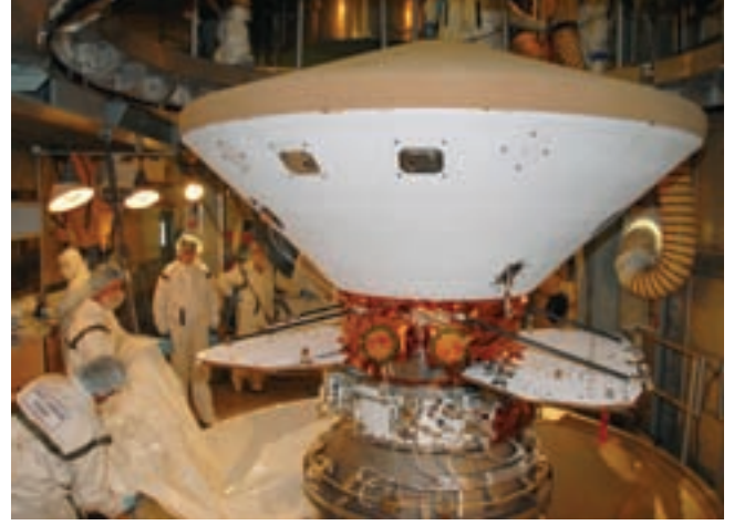
Uzay araçlarının Mars'ın atmosferinde yaklaşık 7 dakika süren yolculuğu sürtünme nedeniyle çok sıcak geçiyor. Bunu bilen tasarımcılar Phoenix zarar görmesin diye onu, önünde ısı kalkını taşıyan bir kapsülün içine yerleştirdi.
