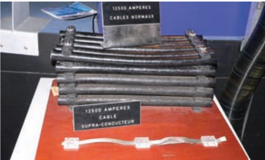
CERN'de eski ve yeni teknoloji birarada: LEP'te (Large Electron-Proton Collider - Büyük Elektron-Proton Çarpıştırıcısı) kullanılan geleneksel kablo ve hemen önünde LHC'de (Large Hadron Collider - Büyük Hadron Çarpıştırıcısı) kullanılan süperiletken kablo.
