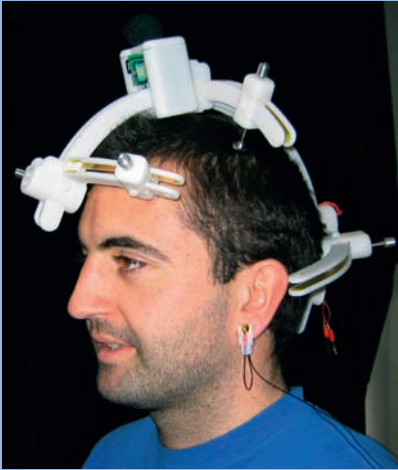
Buradaki özel tasarımı başlık, özellikle beyin görme merkezi üzerindeki sinirsel aktiviteyi algılamak üzere tasarlanmıştır.
