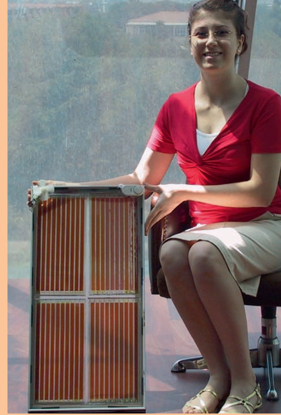
E.Ü. Güneş Enerjisi Enstitüsünde üretilen %2,5 verimli organik boyar maddeli güneş pili paneli.
