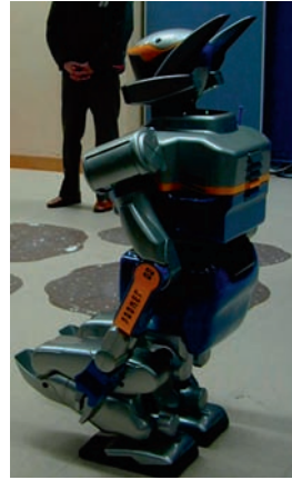
HRP2'nin mekanik yapısı yere yatmak, ve düşmesi durumunda yerden kalkmak da dahil bir çok hareketine olanak tanıyacak şekilde tasarlanmıştır.
