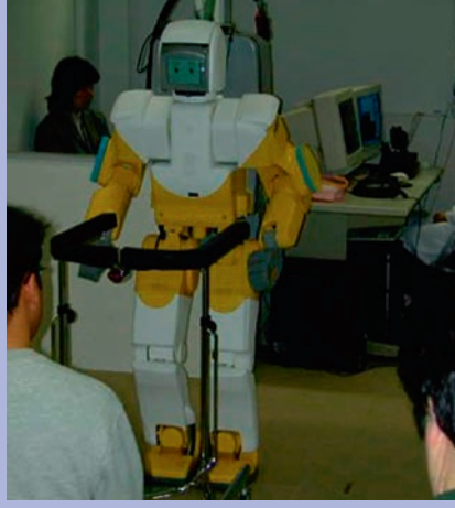
HRP çerçevesinde Honda P3'ün mekanik sistemi de kullanıldı. Robot bir hastane ortamı senaryosunda hastasına ilaçlarını ve tekerlekli bastonunu getiriyor.
