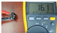
Şekil 16 Yüksek değerli direnç ölçümü
