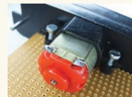
Şekil 13: Motorların gövdeye montajı
