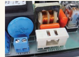
Şekil 24: Güç kaynağının giriş kısmı
