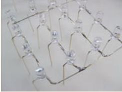
Şekil 13: LED gruplarını lehimleme
