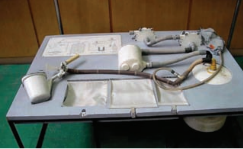
Rusların Soyuz uzay aracında kullandıkları tuvalet çok ilkel olmasına karşın etkin bir şekilde görevini yerine getiriyordu. Araç, MIR uzay istasyonuna gidiş ve geliş için kullanıldığı için uçuş kısa sürüyordu ve katı atık için olan kısım pek kullanılmıyordu.
